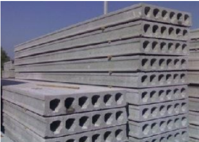
Рис. 50. Железобетонные плиты перекрытий
