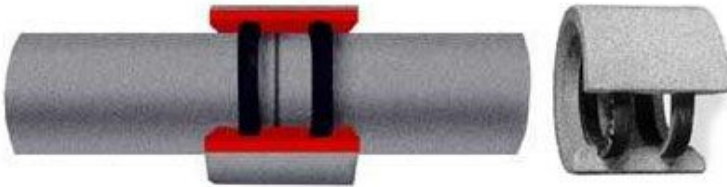
Рис. 63. Самоуплотняющаяся асбестоцементная муфта ( справа ) и принцип соединения труб с ее помощью ( слева )
